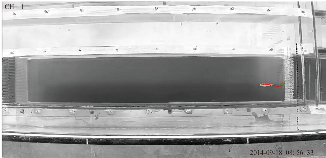
图5 运用Fish Trajectory程序定点跟踪分析鱼类身体中线
