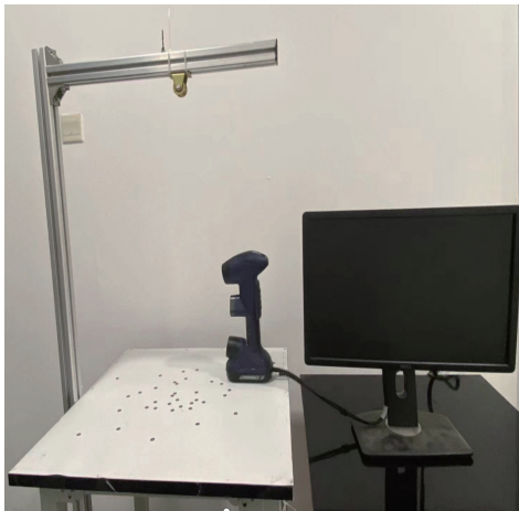
图1 鱼类三维点云数据采集装置
