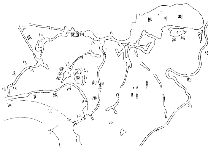
图 1 常德市污水排放系统和采样点示意图
